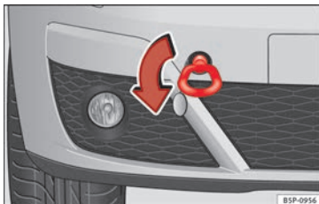
Fig. 165 Atornillado de la argolla de remolque en la parte delantera derecha del vehículo.
