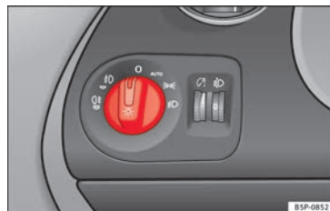
Fig. 59 Encendido automático de luces.
