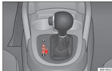
Fig. 126 Consola central: palanca selectora del cambio automático.
