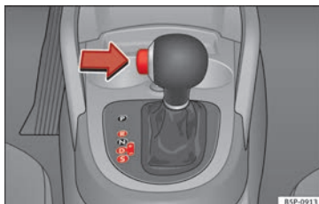
Fig. 127 Consola central: palanca selectora del cambio automático.
