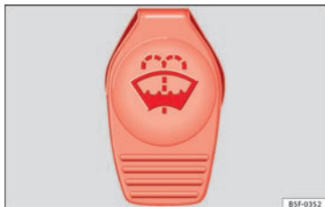
Fig. 150 Tapón del depósito del lavacristales en el vano motor.
