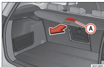
Fig. 105 Accionamiento de la bandeja portaobjetos.
