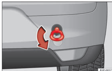
Fig. 166 Atornillado de la argolla de remolque en la parte trasera del vehículo.
