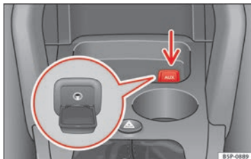
Fig. 99 Conector para la entrada auxiliar de audio.
