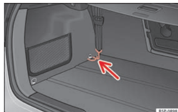
Fig. 108 Argollas de amarre para tensar la red separadora.
