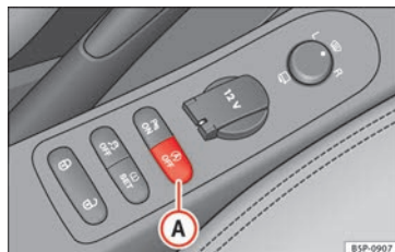
Fig. 132 Detalle del pulsador del funcionamiento Start-Stop.
