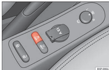
Fig. 131 Detalle de la consola central: tecla ESC.
