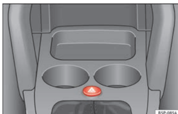
Fig. 63 Tablero de instrumentos: conmutador de los intermitentes de emergencia.
