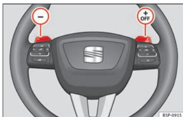
Fig. 129 Volante con palancas para cambio automático.
