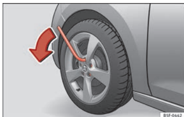
Fig. 157 Cambio de rueda: aflojar los tornillos de rueda.
