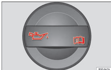
Fig. 148 Tapón de la boca de llenado de aceite del motor en el vano motor.
