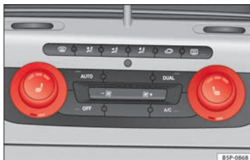
Fig. 78 Calefacción de los asientos delanteros con Climatronic.
