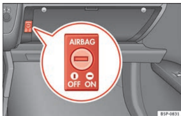
Fig. 19 En la guantera: conmutador con llave para activar y desactivar el airbag del acompañante.
