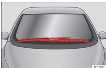
Fig. 169 Limpiacristales en la posición para realizar el cambio.
