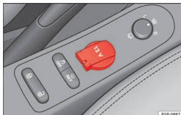
Fig. 97 Toma de corriente en la consola central delantera.
