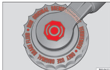
Fig. 151 Vano motor: tapón del depósito del líquido de frenos.
