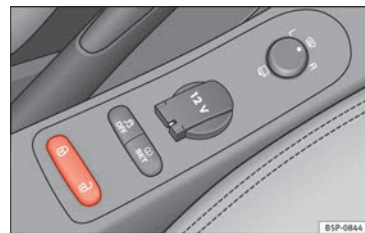
Fig. 47 Detalle de la consola central: pulsador del cierre centralizado.
