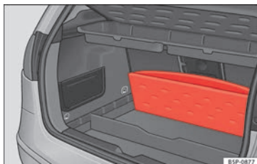
Fig. 109 Portaobjetos variable en el suelo del maletero.
