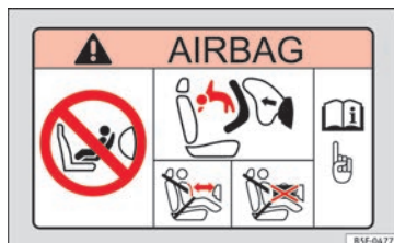
Fig. 21 Parasol del lado del acompañante: adhesivo del airbag.
