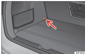
Fig. 24 Anilla de sujeción Top Tether*.
