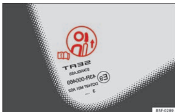
Fig. 6 Etiqueta de advertencia de la posición del apoyacabezas.
