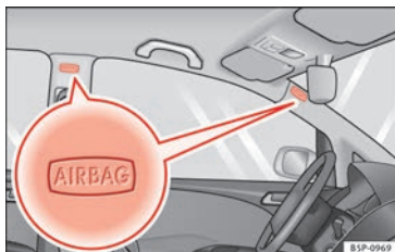
Fig. 17 Ubicación de los airbags para la cabeza en el lado izquierdo del vehículo.
