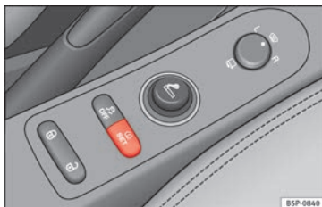
Fig. 32 Consola central: tecla del sistema de control de los neumáticos.
