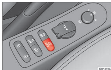
Fig. 121 Consola central: conmutador de control del sistema de gas.
