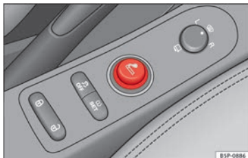
Fig. 96 Encendedor alojado en la toma de corriente de la consola central anterior.
