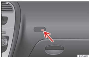
Fig. 20 Testigo de control de la desactivación del airbag del acompañante.
