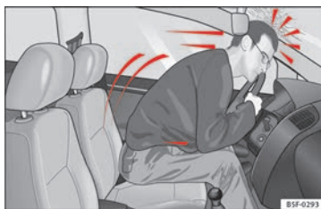
Fig. 8 El conductor que no lleve puesto el cinturón de seguridad se verá lanzado hacia delante.
