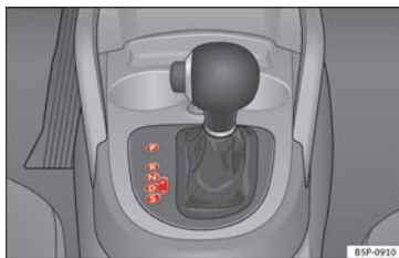
Fig. 125 Consola central: palanca selectora del cambio automático/cambio automático DSG.
