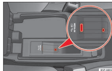
Fig. 101 Conexión en el reposabrazos central.
