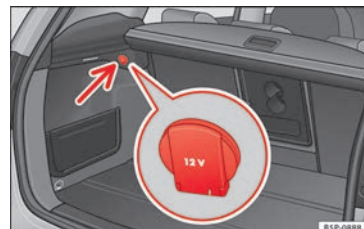
Fig. 98 Modelo Altea XL/Freetrack: toma de corriente en el maletero.
