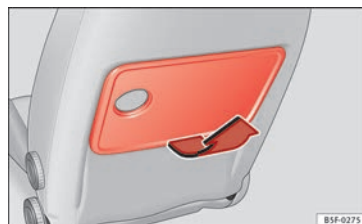
Fig. 86 Mesita plegable del asiento delantero izquierdo.
