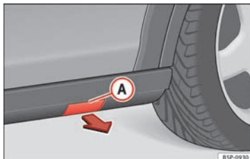
Fig. 160 Talonera de plástico con tapa para el anclaje del gato.
