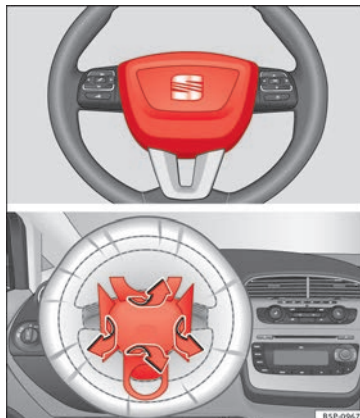
Fig. 13 Airbag del conductor en el volante.
